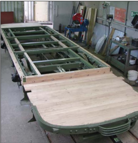
Das Fahrgestell ist fertig, der Holzaufbau beginnt. Aufnahme: 27. März 2011 - Krzysztof Stryszowski
